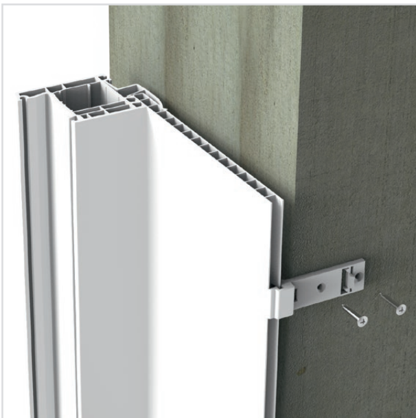
3 Die Lasche mit der Wand verschrauben.
